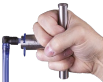
Extraction d'un chalumeau
