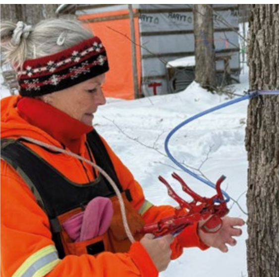
Mini pince d'installation ajustement à vis tube 3/16"
